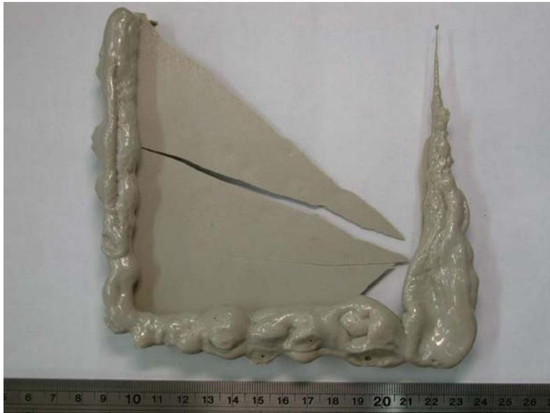
圖 4.3 熱壓成型時溫度過高下之高分子 PEEK 板材
