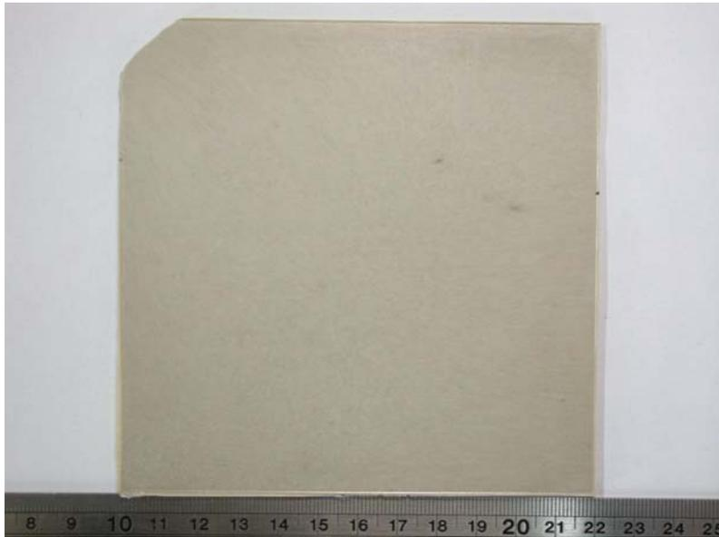
圖 4.6 在最佳條件下熱壓成型之高分子 PEEK 板材上表面外觀圖
