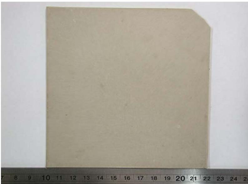
圖 4.7 在最佳條件下熱壓成型之高分子 PEEK 板材下表面外觀圖
