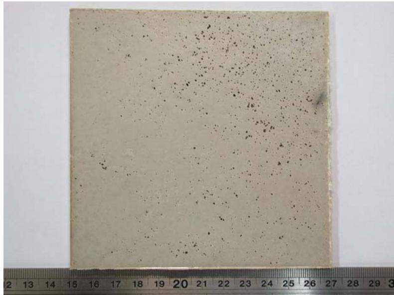
圖 4.5 熱壓成型時真空度有問題下之高分子 PEEK 板材
