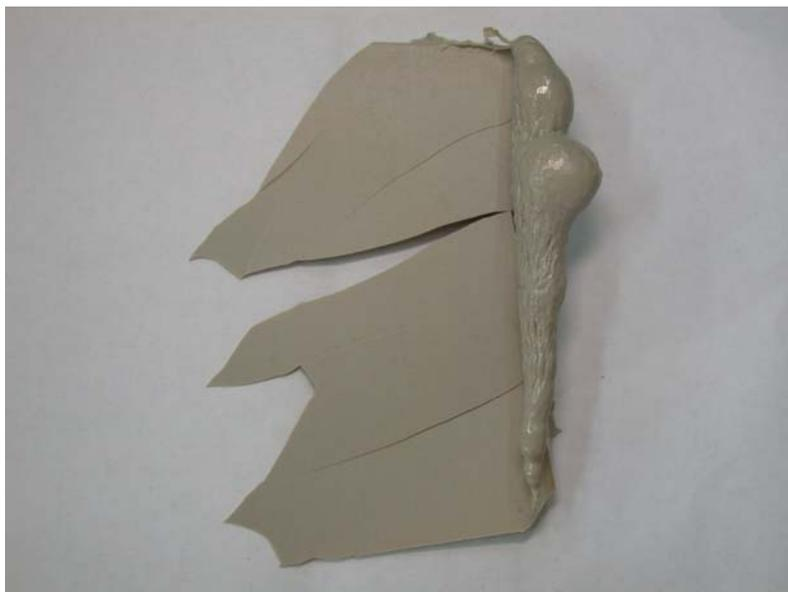
圖 4.4 熱壓成型時壓力過大下之高分子 PEEK 板材
