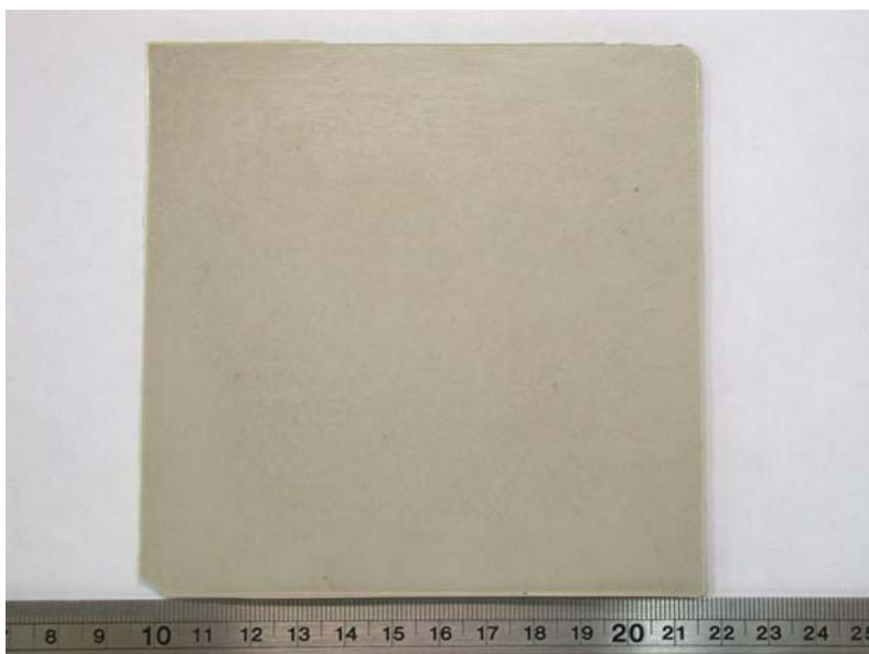
圖 4.1 高分子 PEEK 熱壓成型之板材上表面外觀圖
